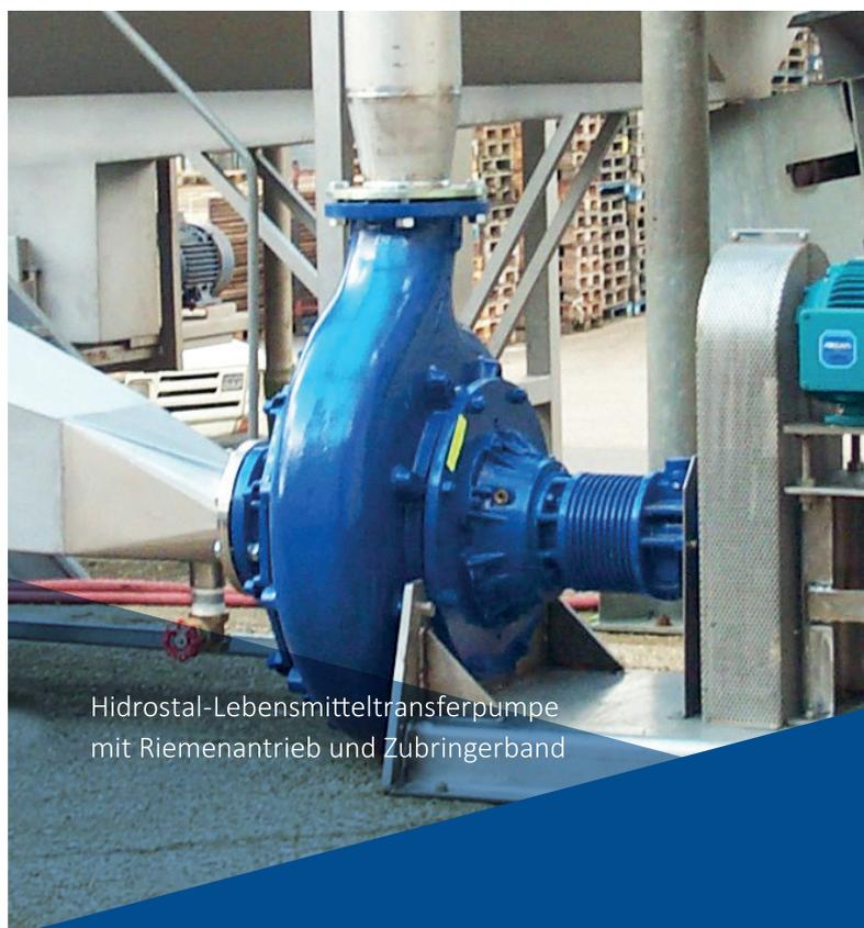
Hidrostal-Lebensmitteltransferpumpe mit Riemenantrieb und Zubringerband
